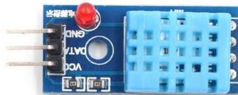
Gambar 3 Sensor DHT 11
